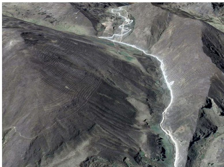
Figura 4. Zanjas de infiltración realizadas por la Comunidad de Pillao Matao, en San Jerónimo, (Cusco, Perú) en colaboración con la ONG Guaman Poma de Ayala. Esta comunidad se abastece gracias a una galería drenante de 180 m de longitud situada aguas abajo (realizada por la citada ONG), en el sentido del flujo subterráneo, de las zanjas de infiltración.
